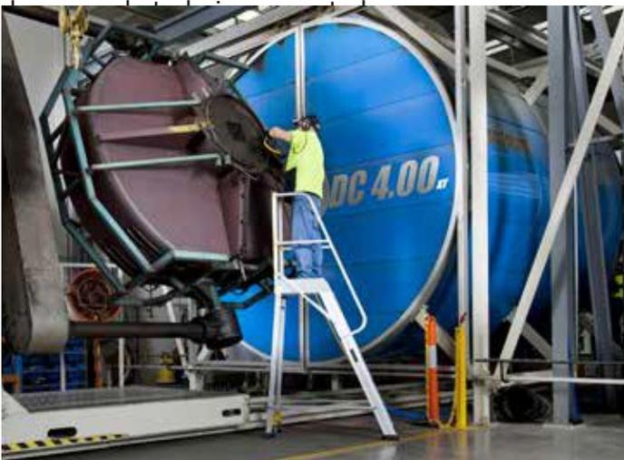
Sealite es uno de los únicos productores de una línea completa de ayudas a la navegación que fabrica boyas marinas in situ con equipos de rotomoldeo de vanguardia. La fabricación en nuestras instalaciones nos permite garantizar que las boyas marinas sean robustas y capaces de soportar las condiciones climáticas más severas.
