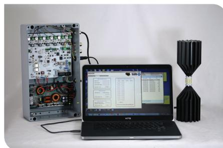
Représentée avec le contrôleur à DEL universel, la source lumineuse est facile à programmer avec l'outil de programmation pour PC de Sealite.
